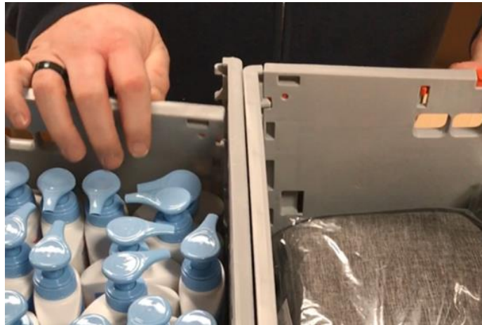
Abbildung 20: Handlungstest mit Behälterarretierung
